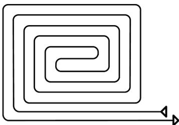
Die Leitungen werden schneckenförmig verlegt. Vor- und Rücklaufleitungen wechseln gegen das Zentrum des Registers ab. Die Bodentemperaturen sind bei dieser Verlegeart ausgeglichen. An den Rändern können die Leitungen mit sehr geringen Abständen verlegt werden. Die schneckenförmige Verlegeart ist aufwändiger und erfordert einen höheren Planungsaufwand.
