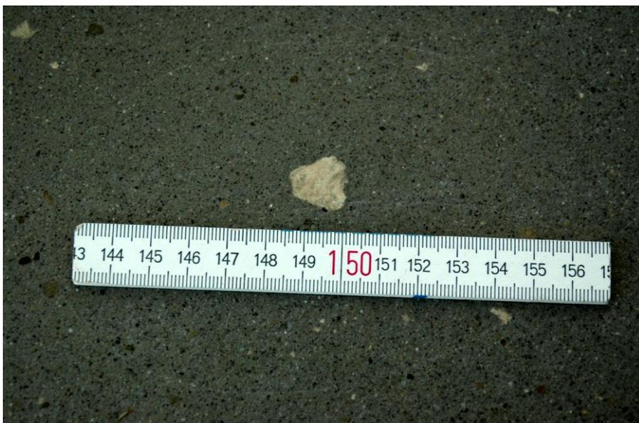
Un morceau de liant de sulfate de calcium «non mélangé». Ce genre de morceau et d'autres «impuretés» doivent être acceptés étant donné que de telles «incrustations» ne peuvent pas être exclues.
