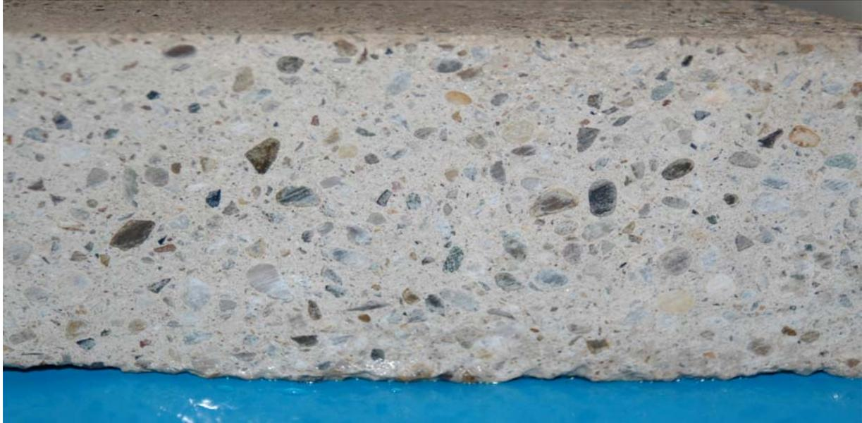
Posé correctement, le **mortier fluide KBS** présente une **surface solide**. Les granulats sont répartis régulièrement sur toute la section. Il n'y a aucune "couche de frittage".
