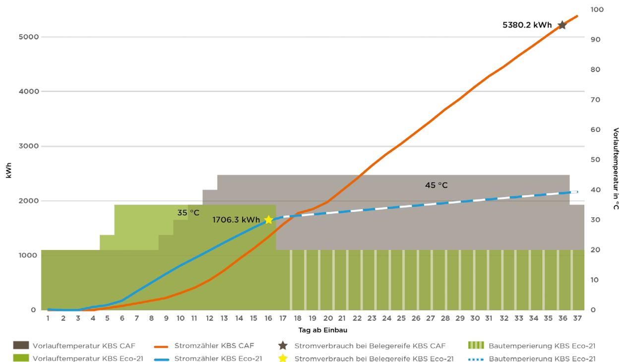
Hinweise: Während der Trocknungszeit wurde 3-mal täglich ein Stosslüften durchgeführt (alle Fenster ca. 30 Minuten komplett geöffnet) und zum Erfassen des exakten Energieverbrauchs wurden zwei separate mobile Elektroheizzentralen installiert.
